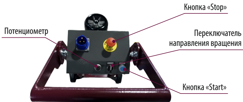
Рис. 4 Схема расположения кнопок управления
