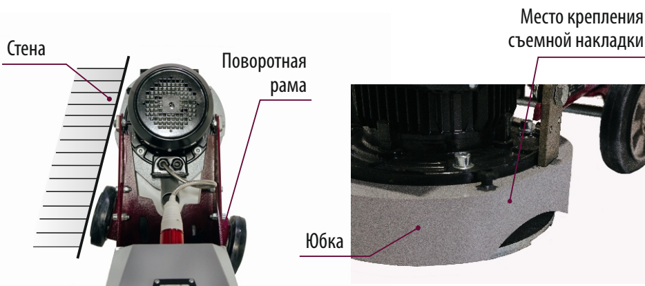
Рис. 2 Шлифовка вдоль стен
